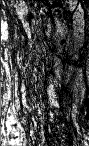
FIGURA 1. Trama vítrea tipo vacuolar. Toba 1, suelo Talca. LNx40. FIGURE 1. Vitreous fabric vacuolar type. Tuff 1, Talca soil. LNx40.
