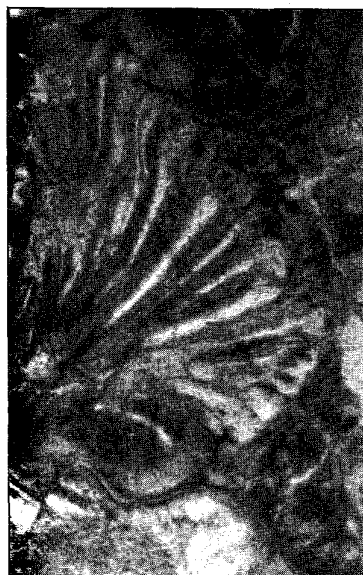
FIGURAS 10, 11 y 12. Secuencia de alteración de los cristales de "vermiculitas primarias". LNx40. FIGURES 10, 11 and 12. Alteration sequence of crystals from "primary vermiculites". LNx40.
