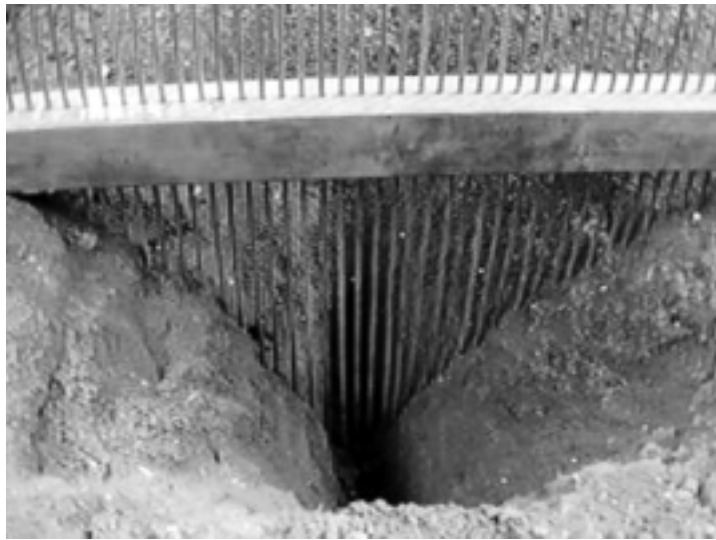
Figura 4. Esquema del perfilómetro para determinar el área disturbada por las herramientas. Figure 4. Schematic representation of the profile-meter to determine the area disturbed by the tools.
